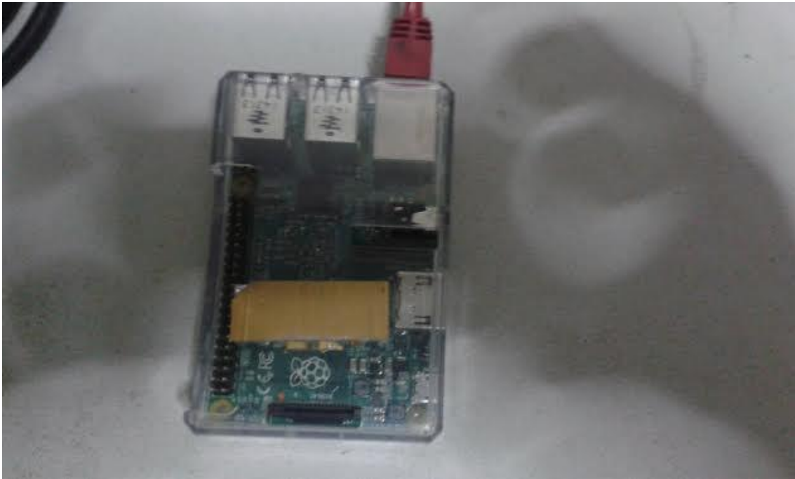
Raspberry pi utilizada como servidor
