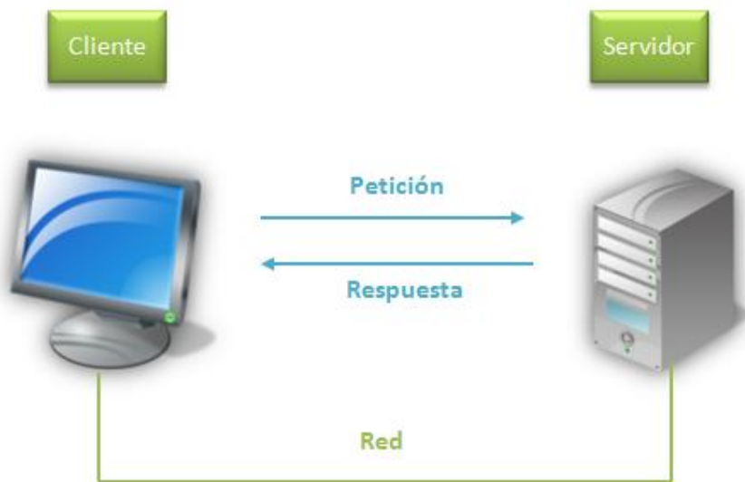
Imagen 1 Ilustra el modelo Cliente-Servidor donde el cliente envió una petición y el servidor emite una respuesta.
